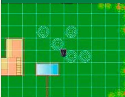
Die F35S & F50S erzeugen durch die satellitengestützte Navigation eine virtuelle Grundstückskarte und erkennen so die bereits gemähten Rasenflächen.
